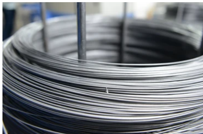
Alambre desnudo termopar tipo K: Alumel y Cromel
