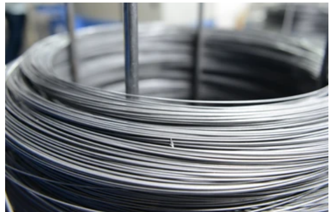
Alambre desnudo termopar tipo K: Alumel y Cromel
